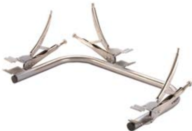
AT-059N: Pinça para fixar cabos, impedindo a separação durante a fusão. Complementa a AT-049N ou AT-050N em qualquer conexão que implique cabo de passagem.
