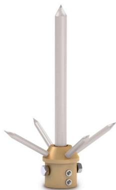
Multiponta com peça de adaptação em latão. Uso adequado com mastro de 1½" de aço galvanizado (por exemplo AT-056A, tabela 30).
